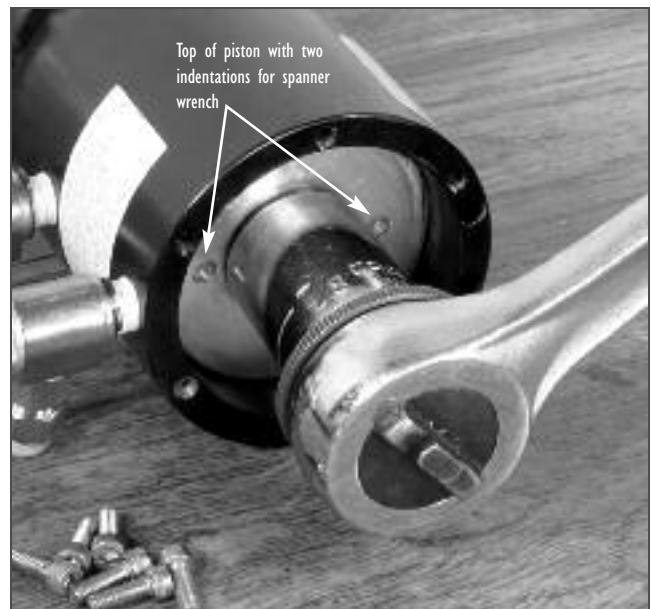
Remove hex jam nut
